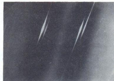
Figur 7. Oppsplitting av Kikuchilinjer i silisium. Effekten er utnyttet til å bestemme strukturfaktor (Terasaki et al.<sup>5</sup>).
