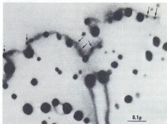
Figur 3. Kopperholdige utfellinger på en dislokasjon i silisium. Vekst av partiklene er knyttet til bevegelse av dislokasjonen (Solberg<sup>1</sup>).
