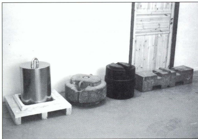
Figur 2. Forskjellige 500 kg loddnormaler som benyttes. Den til høyre er av austenittisk stål, mens de andre er laget av jern og støpejern. Loddnormalen av austenittisk stål har liten følsomhet for magnetiske felt da denne legeringen normalt vil være umagnetisk.
