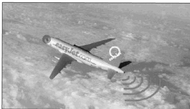
Figur 3. En skisse av en easyJet Airbus med AVOID montert på halevingen. Data overføres til cockpit og til bakken, og varsler piloter og bakkepersonell om askeskyer opptil 100 km foran flyet.
