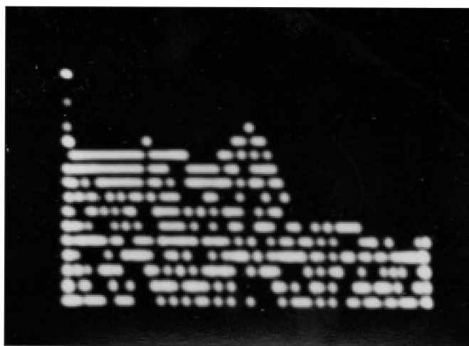
Figur 3. Spektret av nukliden Zn65 med en karakteristisk gammastråling av energi 1,12 MeV. Horisontalaksen er delt i kanaler som gir pulshøyden, dvs. strålingens energi. Antall registrerte pulser i hver kanal angis som binære tall, og pulstallaksen blir logaritmisk i 2^n . Den typiske toppen i spektret er uttegnet i lineær skala i figur 4.
