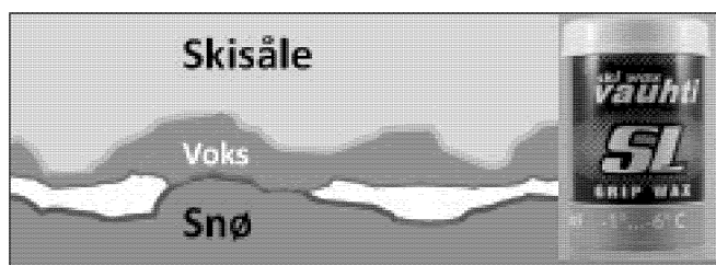
Figur 5. Skjematisk illustrasjon av smurt ski: Skisole med lag av smurningsvoks under i kontakt med snø. Finsk festevoks boks plassert til høyre i bildet.
