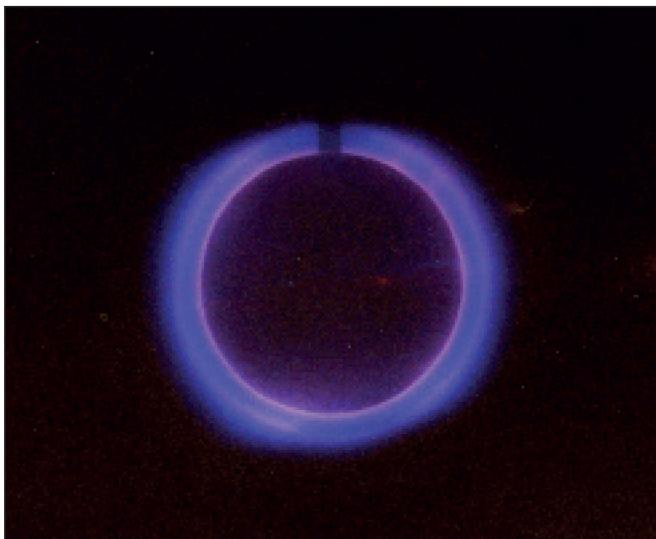
**Figur 6.** "Solens korona" på en terrella uten magnetfelt i 1996. Dette gir en jevnt fordelt gassutladning.
