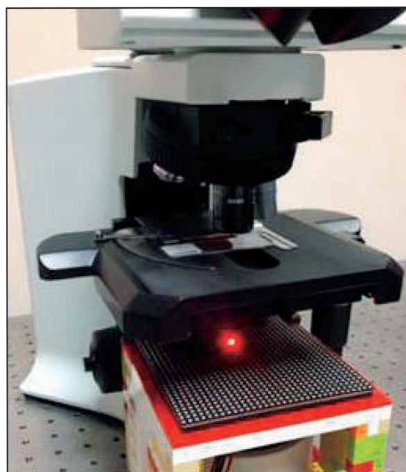
Figur 3. Bilde av mikroskop utstyrt med LED-belysning. Ved å ta en serie lavoppløste bilder med forskjellige LED-lamper tent, fås et datasett som ved hjelp av numeriske algoritmer kan settes sammen til et høyoppløst bilde. (3) (Gjengitt med tillatelse fra Nature Publishing Group).
