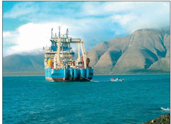
**Figur 3.** Kabelskip fotografert på Svalbard i juli 2003, under legging av lysleiande sjøkabel (frå Teletronikkartikkelen).
