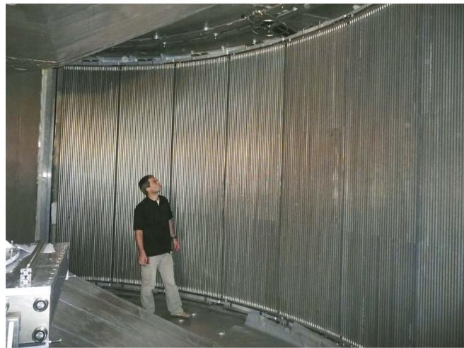
**Figur 6.** Detektoren til IN5-instrumentet (spektrometer) ved Institut Laue-Langevin i Grenoble (ILL). Her benyttes rør fylt med  ${}^3\text{He}$  for nøytrondeteksjon. Totalarealet er  $30 \text{ m}^2$  (fra ILL (L. Didier), 2008).
