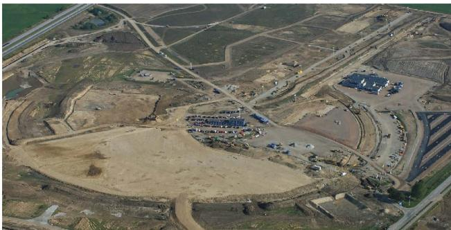
**Figur 2.** Grunnarbeidet for ESS startet høsten 2014. Det vifteformede området hvor instrumenthallen skal plasseres, ses nede til venstre. Første stadium av akseleratortunnelen oppe til høyre. Denne tunnelen vil bli 500 m lang. Målskiven hvor nøytroner dannes ved spallasjon, vil befinner seg omrent midt på bildet.
