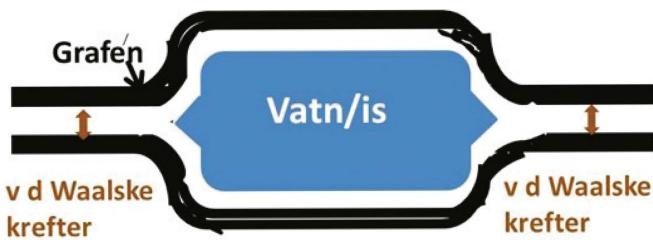
Figur 1. To grafén-flak haldne saman av van der Waalske krefter, med ei inklusjonsøy av vatn/is.
