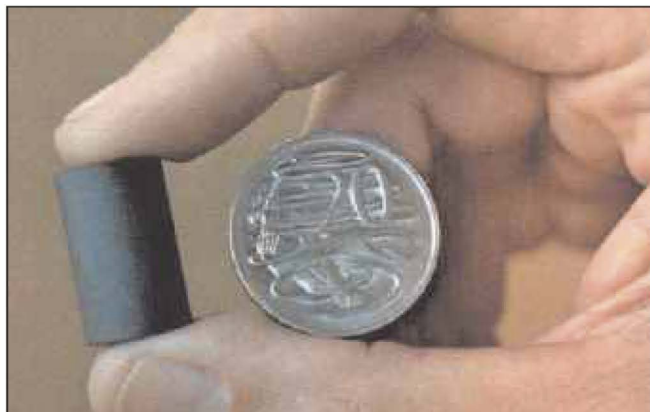
Figur 2. Brenselspellet til venstre, sammenliknet med størrelsen av en mynt.
