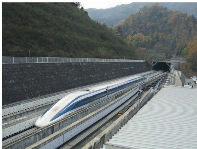
Figur 1. Det japanske toget Maglev i sin "guideway". Spolane som ligg inne i dei solide bjelkeveggane (spolehus) på begge sider av toget, vekselverkar med superleiar-magnetane og både løfter toget, driv det fram og styrer det. (For å sjå dette toget i fart, skriv inn teksten: "riding the superconducting maglev train" på Google). Den spesielle "snuten" hjelper til med å redusere luftmotstanden, den viktigaste friksjonskrafta.
