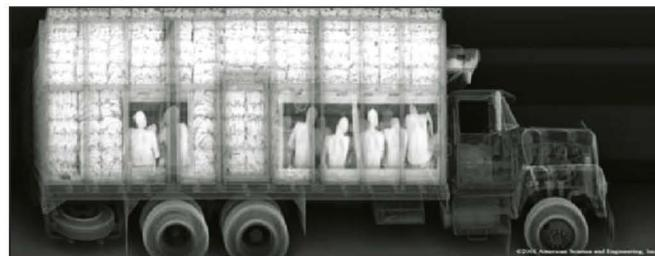
**Figur 10.** Bildet viser et eksempel på bruk av Comptontilbakespredningsteknologi i forbindelse med menneskesmugling.
