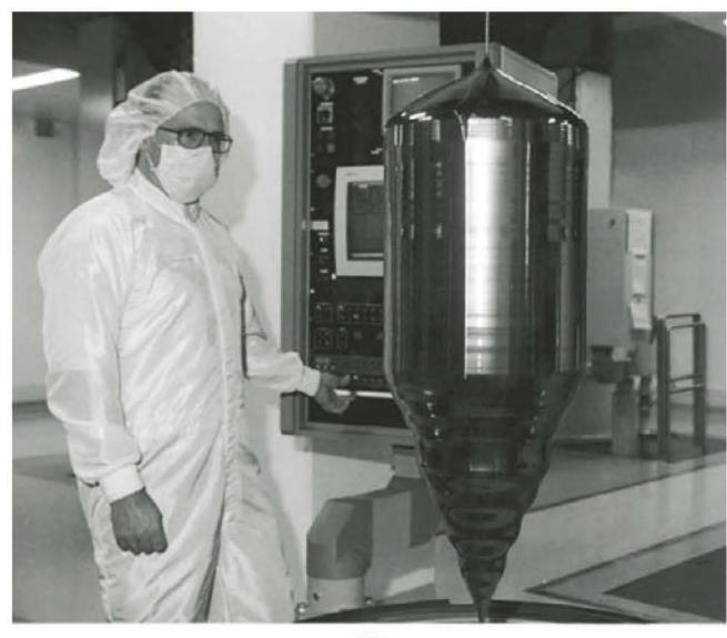
Figur 4. Ferdig silisiumstøvp med diameter 30 cm.
