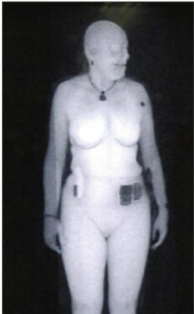
**Figur 8.** Dette bildet fra 2003 av Susan Hallowell i TSA, viser hva som er mulig å se med tilbakesprett røntgenstråling. I dag kan en få bedre bilder. Det har ført til at instrumentene nå "sladder" kroppen som en hvit tegning. Men de virkelige bildene kan lagres og sees på i tilfelle terrorhandlinger.
