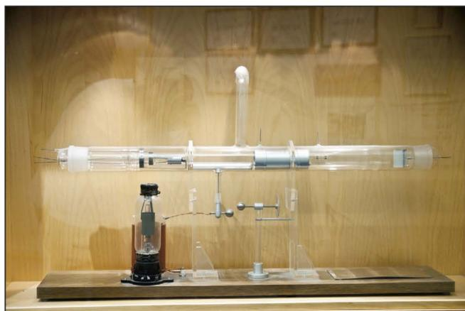
**Figur 3.** Modell av verdens første lineærakselerator. Modellen er en tro kopi av originalapparatet. Den ble bygget på Radiumhospitalet i 1985 under ledelse av Rolf Widerøe.
