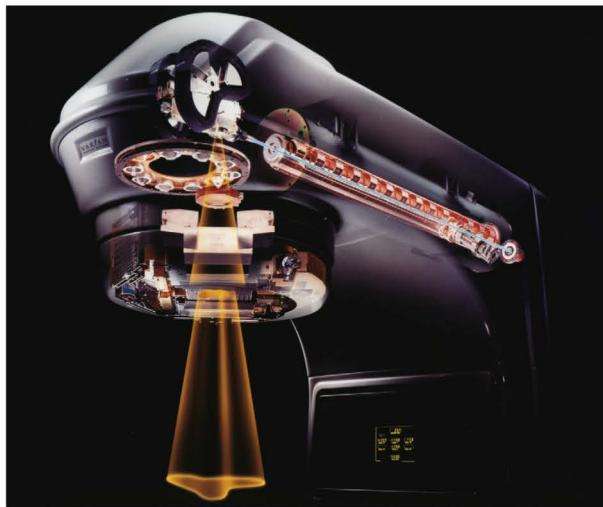
**Figur 6.** "Gantry" på en lineærakselerator med vandrebølgerør for akselerasjon av elektroner. Elektronene kan enten tas ut direkte eller bremses i et target for dannelse av røntgenstråling ("bremsstrahlung")
