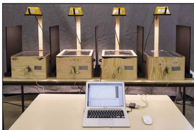
Figur 3. Fire drivhus på rekke med lamper, temperaturfølere og datalogger. Mellom drivhusene har vi svartmalte vegger for å hindre at lys fra en lampe også kommer inn i nabodrivhus.
