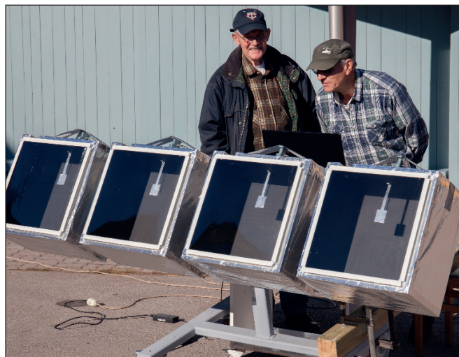
Figur 6. Forsøk med fire drivhus med forskjellig innhold av CO 2 . Drivhusene er montert på stativ hvor vinkel og retning kan endres slik at drivhusene følger sola. Inne i drivhusene er det montert en liten skjerm foran sensorhodet slik at dette ikke blir belyst av sola.
